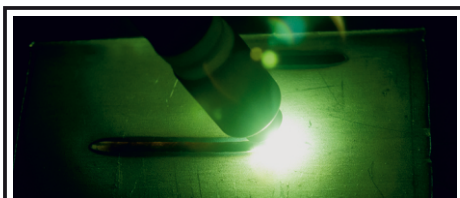
Что видит сварщик через обычный светофильтр.
